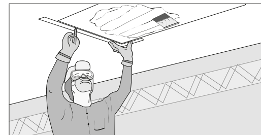
Fig.7. Dibuje en el techo un rectángulo del tamaño de la abertura preliminar, con el borde en paralelo a una de las vigas.
