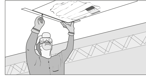
Fig. 7 Dessiner un rectangle de la taille de l'ouverture du plafond.
