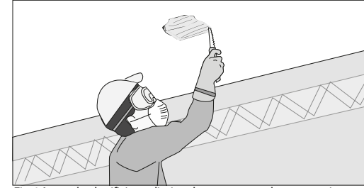
Fig.6. Agrade el orificio preliminar hasta que pueda ver una viga.
